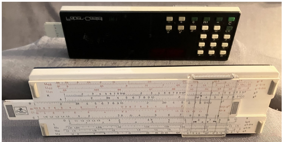
Abb. 1: Faber-Castell TR 1: Versuch sich der Digitalisierung anzupassen. Das Gerät wurde vor einem Spiegel aufgenommen, um die Vorder- und Rückseite gleichzeitig zeigen zu können.
