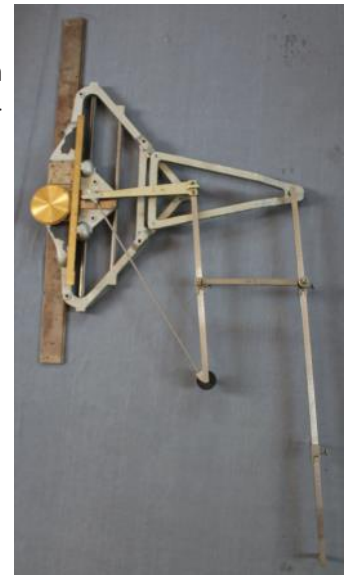
Abb. 13: Montierte Fahrarm-erweiterung (rechts) (Quelle: Sammlung Zerfowski).
