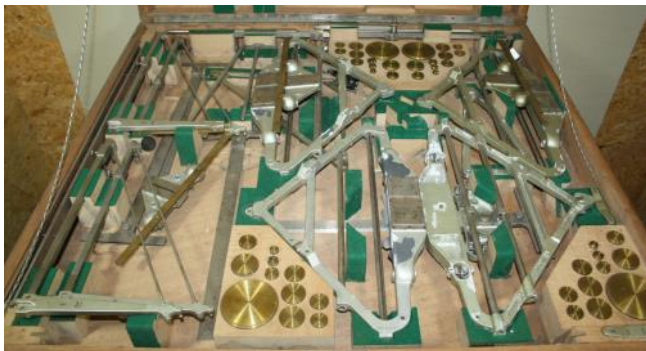
Abb. 12: Aufbewahrungskiste 8-fach Mader-Ott Harmonischer Analysator (SN 2155 bis 2158, Sammlung Zerfowski).
