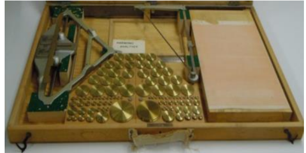
Abb. 7: Mader-Ott Analysator mit zwei Sätzen mit je 48 Zahnrädern [Com2017-1] (Mit freundlicher Genehmigung des Computer History Museum, Mountain View, CA, USA).
