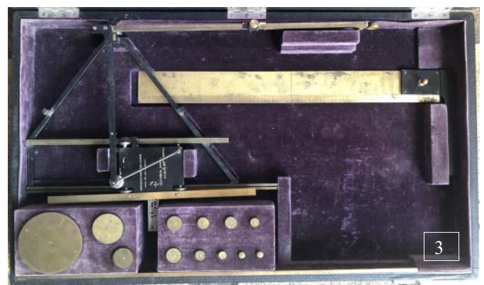
Abb. 3 (oben) zeigt einen Mader Analysator in seiner Aufbewahrungsbox.
