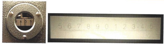
Abb. 7: Links: Grobeinstellung (Vorkommastelle) der Entfernungspolarkoordinate r_1=4,72 . Rechts: Blick durch das Entfernungsmikroskop. Eingestellt sind die Nachkommastellen von r_1 = 4,72 des Punktes 1 aus Abb. 3).
