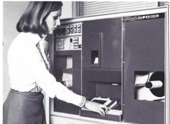
Bild 13: Walther-Almex OCR System [Wal1973]. Die Belegstreifen laufen durch die Maschine und werden maschinell eingelesen.
