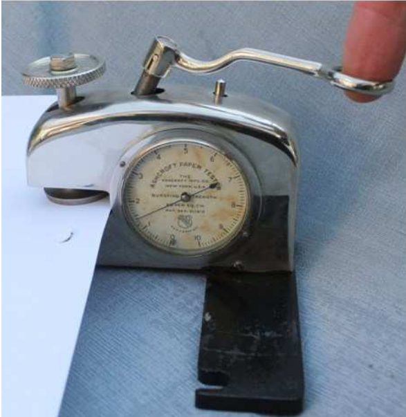
Abbildung 6: Tester (Seriennummer 4164) mit herausgedrehtem Fuß. Das 80g-Druckerpapier birst bei knapp 1,4 kg/cm 2 .
