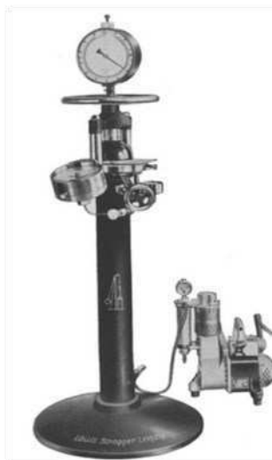
Abbildung 3: Schopper-Dalén Tester mit Luftkompressor [BurKor1944].
