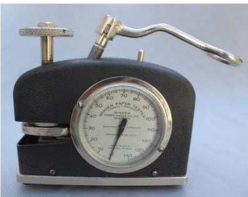
Abbildung 5: Papiertester (Seriennummer 9214) aus den 1940er, zu der Zeit bereits Minden Paper Tester genannt.
